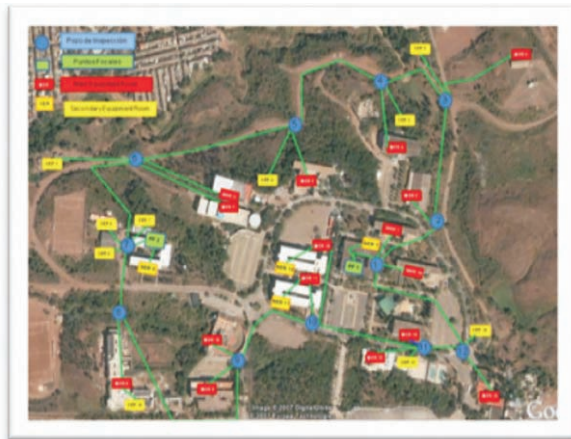
Fig. 3. Red de fibra óptica
